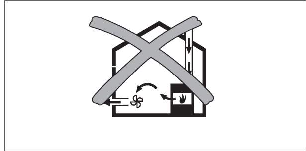
Kuva 4.1 Poistoilman asennus - ei sallittu
