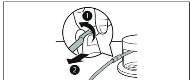
Sl. 6.3 Odstranjevanje vakuumske cevi iz spojke
